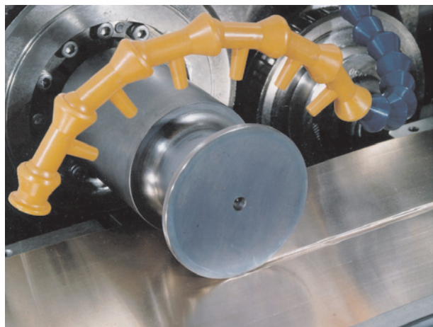
Diese Nahaufnahme veranschaulicht Sauberkeit, Uniformität und Konsistenz der kontinuierlichen Schweißung.
